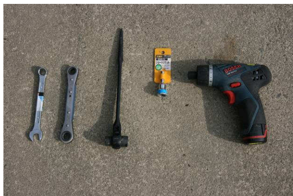
スパナ (13) *平ラジエツト (13) ラジエツト (13) *インパクトレンチ (13) (* : あれば効率的に作業ができる)
